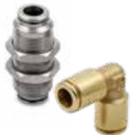
Insteekkoppelingen ontlod messing, serie F-E en F-NSF, leidingdiameter \varnothing 4 tot \varnothing 10, aansluiting M5 tot 1/2".
